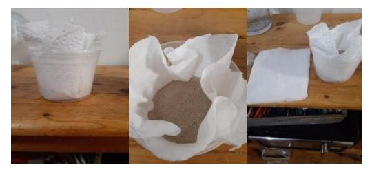
5. Vierta la muestra contaminada en su filtro ¡Asegúrate de tener un recipiente debajo del filtro para recoger el agua filtrada!
